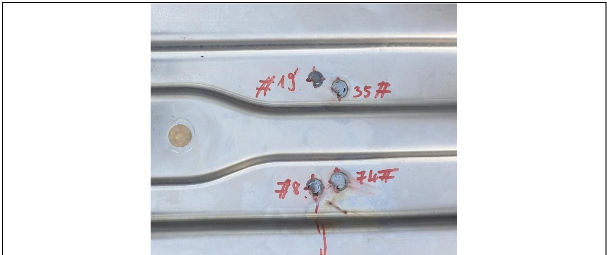
6. ábra A 3D lemezalkatrész a hegesztési varratok helyének megjelölésével
