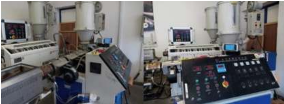
15. ábra A filament gyártáshoz használt extruder
