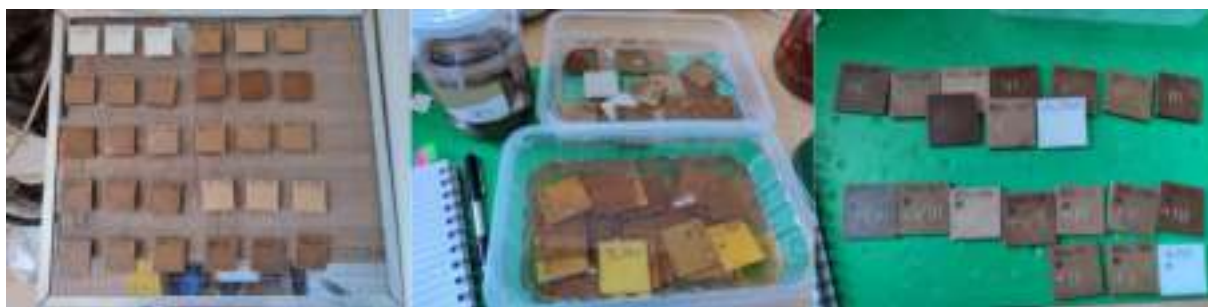
31. ábra Vegyszerállósági vizsgálatokhoz felhasznált próbatestek vizsgálat előtt, közben és után (balról jobbra)
