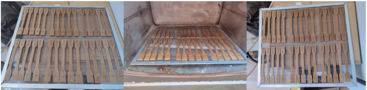
27. ábra 3D nyomtatott próbatestek hőkezelés előtt, közben és után (balról jobbra)
