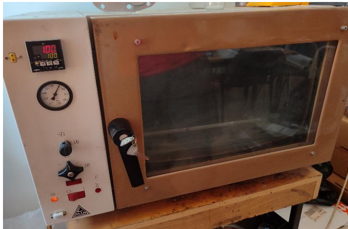
21. ábra Labor-Mix LP404 típusú vákuum szárítószekrény
