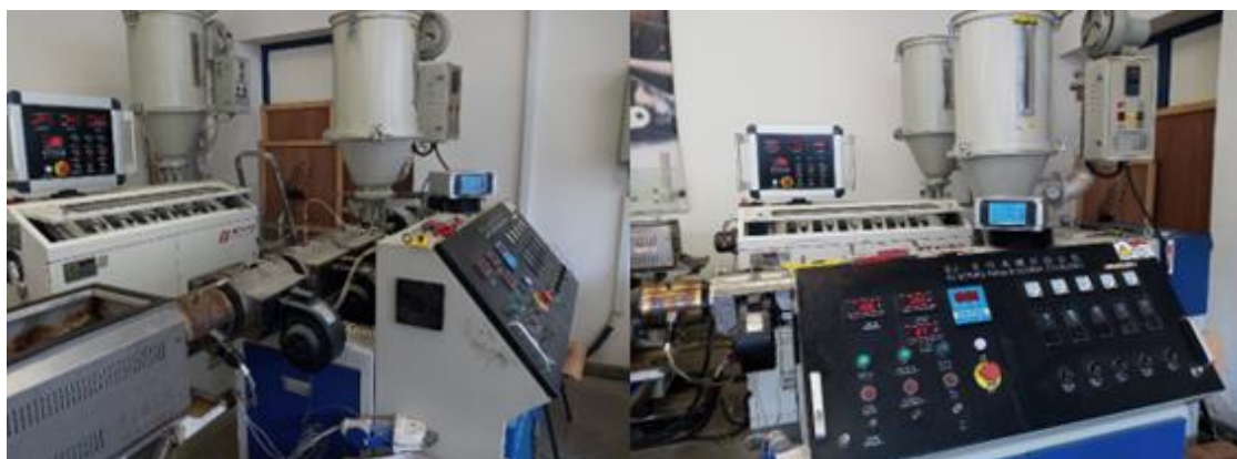
16. ábra A filament gyártáshoz használt extruder
