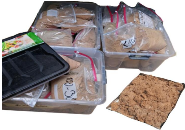
12. ábra Kender ömledék frakcionált állapotban
