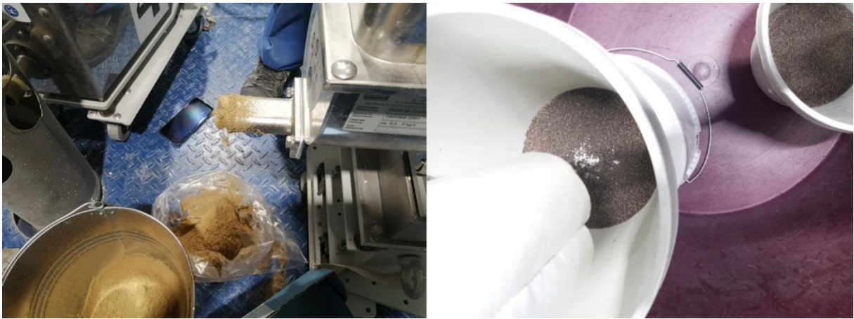
15. ábra Kender őrlemény garatba adagolása (bal oldalt) és a kész granulátum (jobb oldalt)
