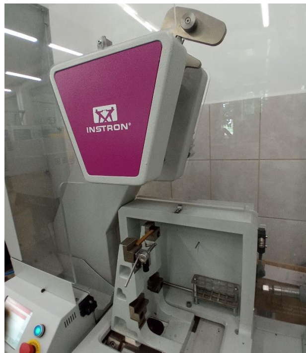
24. ábra Instron® CEAST 9050 Motorized Charpy ütőmű
