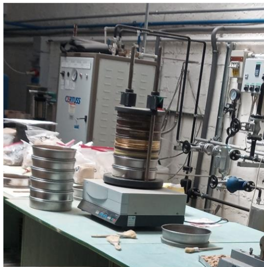
13. ábra Alkalmazott szitálási folyamat
