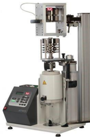
19. ábra: INSTRON MF20 folyásmérő
