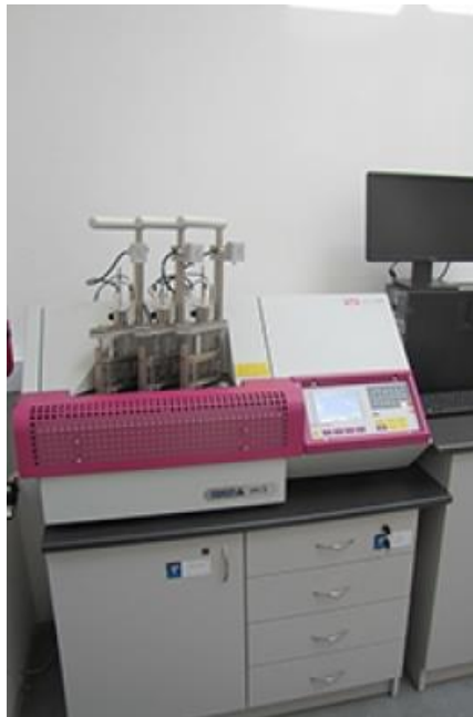
23. ábra: CEAST HV3 6911.000 HDT-Vicat mérőberendezés
