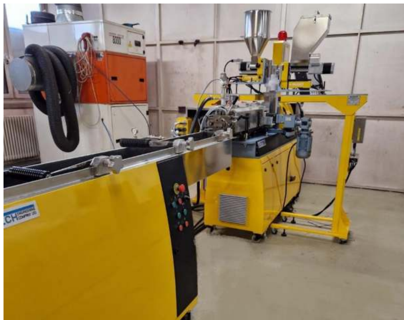
15. ábra: LabTech Scientific LTE26-48/15/01 kétszigás extruder
