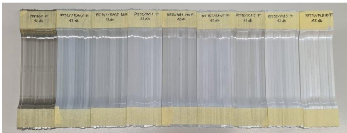
17. ábra: A vizsgált fröccsöntött próbatetek
